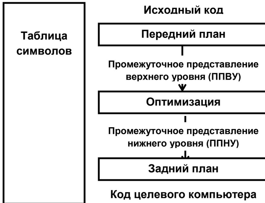
Рис. 1. Архитектура оптимизирующего компилятора
